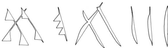
Fig. 15. Afbindingsmærker 41 fra skibets tagværk (s. 3635), fra sydsiden til venstre. Skitse 1:5, KdeFL 1991. - Marks on the rooftrusses of the nave.
