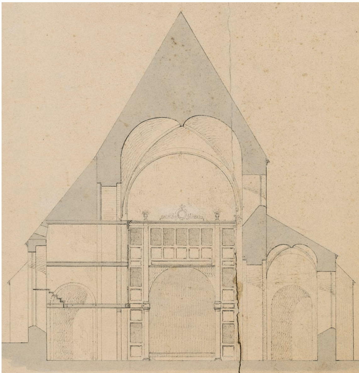
Fig. 94. Tværsnit af skibet mod øst med pulpiter fra Kruuses og Hiernøes ombygning 1794-97 (s. 5486, 5542). 1:150. V.Th. Walther 1864 (jfr. fig. 20). I Horsens Museum. – Cross-section of the nave towards the east with pulpits made by Kruuse and Hiernoe 1794-97 (cf. fig. 20).
