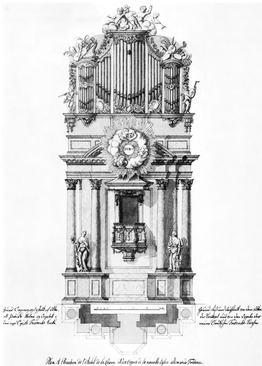
Fig. 45. Christians kirke. Prædikestolsalter og orgel. 1:100. Tegningen er fremstillet, før arbejdet fuldførtes (sml. fig. 42). Efter Thurah, Den danske Vitruvius III, pl. LXIV (p. 124, 148). – Christians Kirche. Kanzelaltar und Orgel. 1:100. Die Zeichnung ist noch vor der Vollendung der Arbeit ausgeführt worden (vgl. Fig. 42). Nach Thurah, Den danske Vitruvius III, Pl. LXIV.
