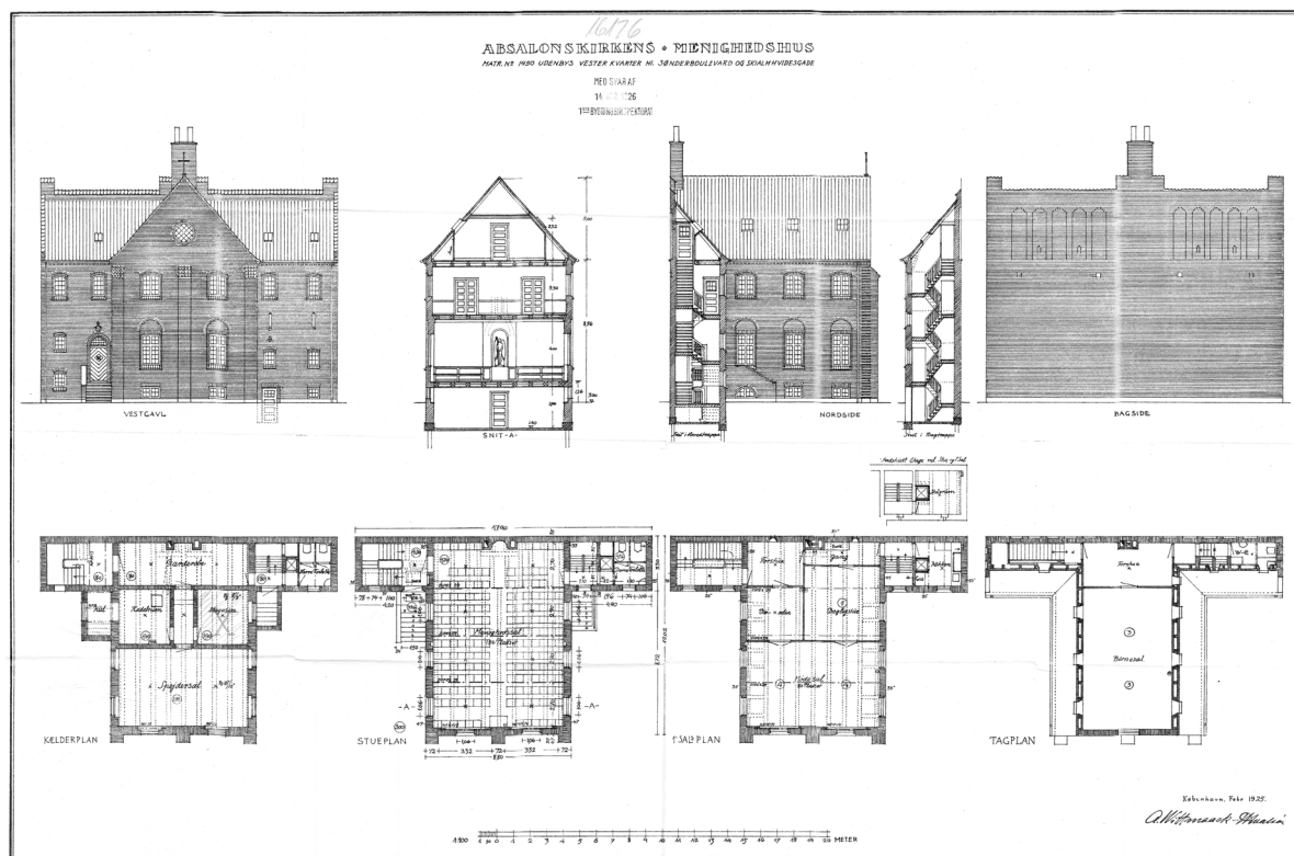
Fig. 5. Menighedshuset. 1:500. Planer, opstalter og snit. Tegning af Arthur Wittmaack og Vilhelm Hvalsøe 1925. Københavns Kommunes Byggesagsarkiv. – The church hall. Plans, elevations and sections.
