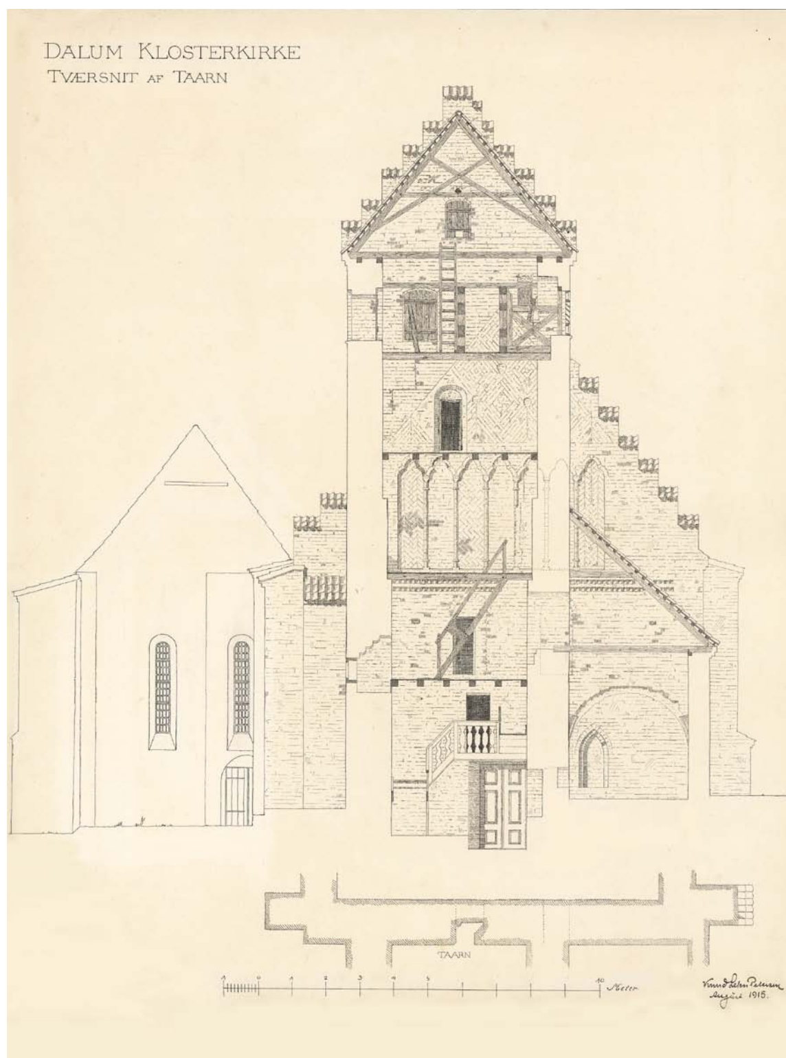
Fig. 8h. Tværsnit gennem tårnet (jf. s. 2800). 1:150. — Cross-section through tower (cf. p. 2800).
