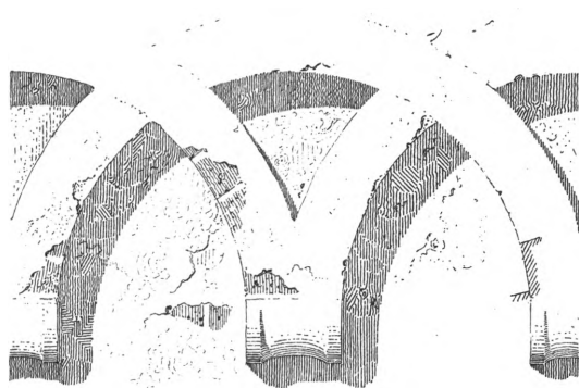
Fig. 13. Udsnit af frise med krydsende rundbuer i skibets nordside (s. 2004). 1:15. Målt og tegnet af V. Koch 1885. Efter Danske Tufstenskirker. – Kreuzbo-genfries an nördlicher Langhauswand. Ausschnitt , 1885. -
