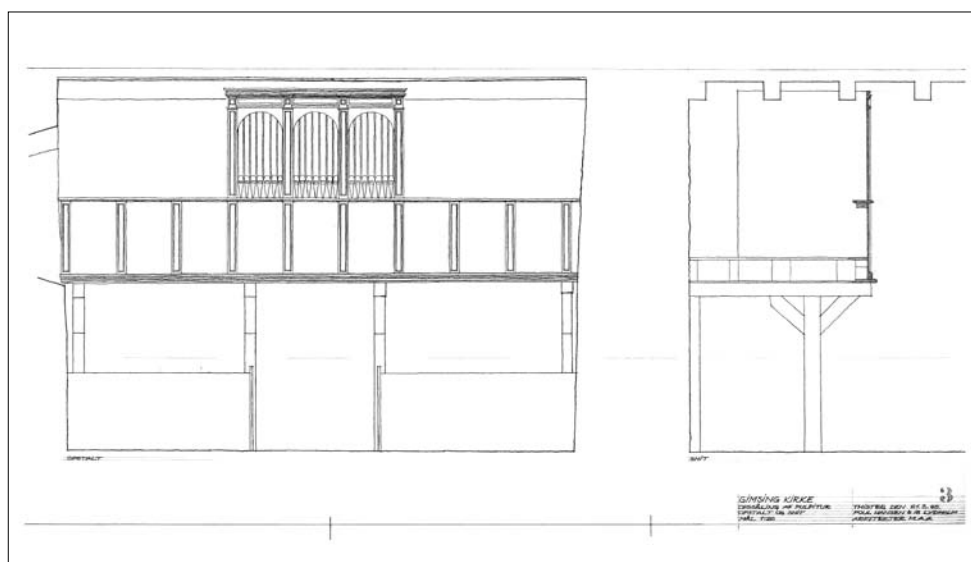
Fig. 48. Pulpitur o. 1590 (s. 2151) og torgel 1901 med ændringer 1929 (s. 2153). 1:100. Målt og tegnet af Poul Hansen og Ib Lydholm 1965. – Empore um 1590 und torgel 1901.
