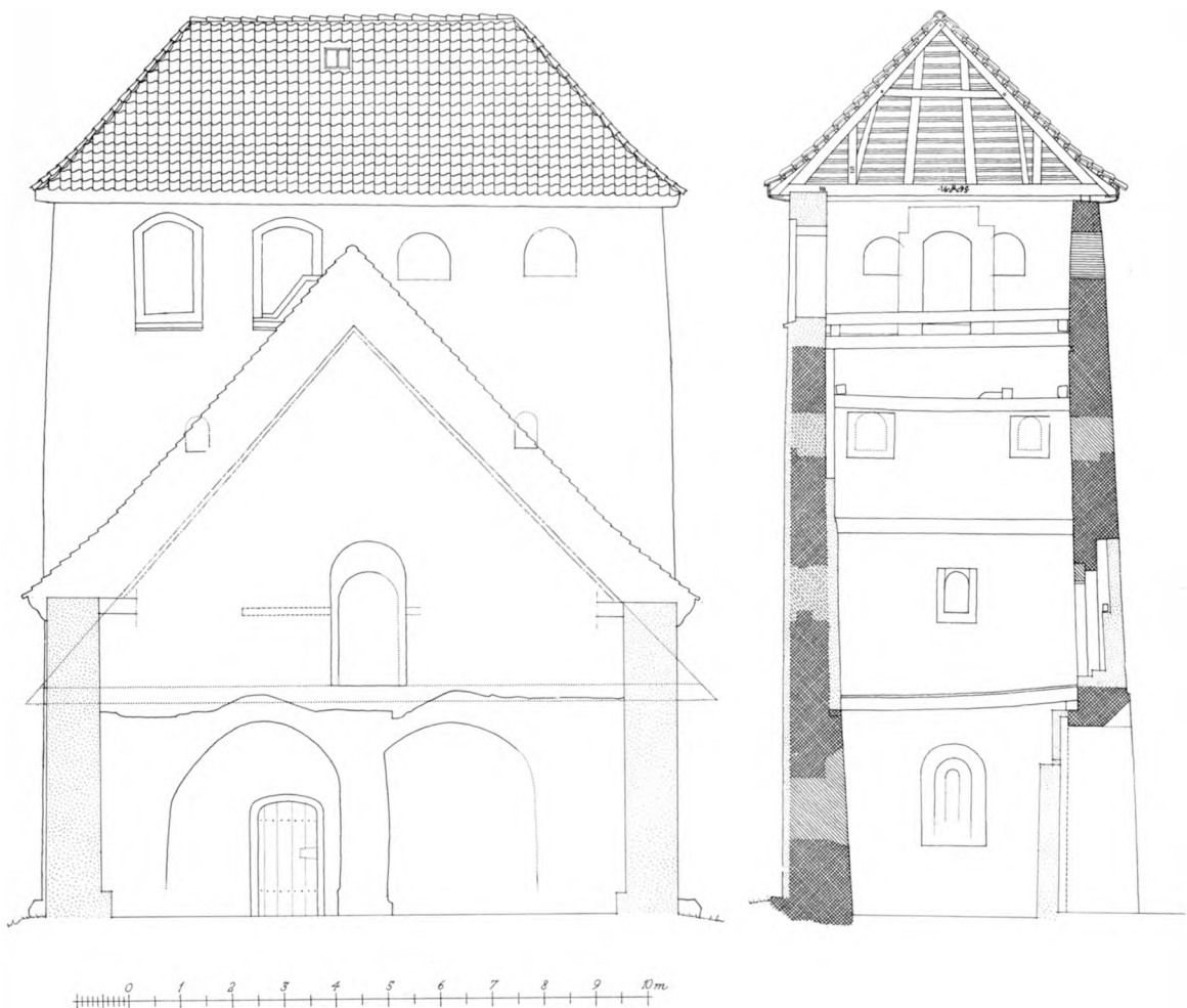
Fig. 3—4 Ketting. 3, snit i skibet fra 1773, set mod tårnets østmur med spor efter det romanske skibs spærfig. 4, snit i tårnet, set mod nord. 1:150. Målt af Holger Schmidt 1960.
