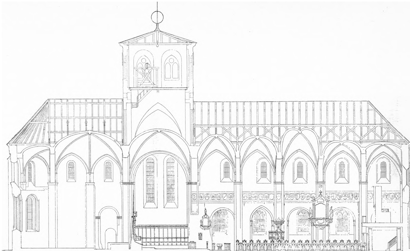
Fig. 14. Ringsted. Længdesnit, set mod Syd. 1:300. Med de gamle Højkirkehvælv, Skjoldefrisen i oprindelig Højde, Alter og Korstole i Korsskæringen. Før Storcks Istandsættelse.
