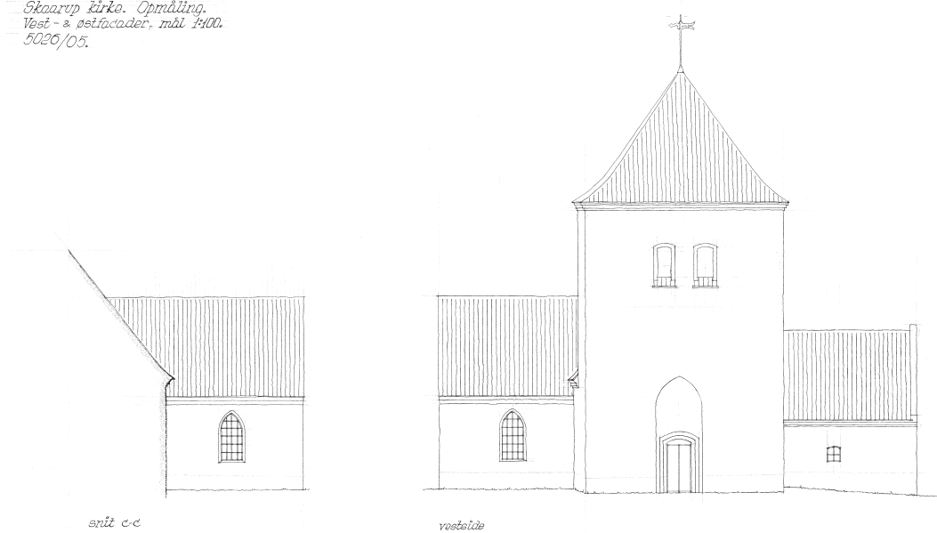
Fig. 12d-f. Opstalter. 1:300. d. Nordfacade. e. Østfacade af korsarm (snit c-c). f. Vestfacade. Målt og tegnet af E. Mindedal Rasmussen 1951. I NM. – Elevations. d. North facade. e. East facade of transept. f. West facade.
