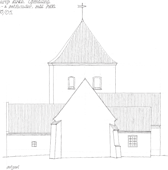
Fig. 12a-c. Opstalter. 1:300. a. Sydfacade. b. Østfacade. c. Vestfacade af sakristi (snit b-b). Målt og tegnet af E. Mindedal Rasmussen 1951. I NM. — Elevations. a. South facade. b. East facade. c. West facade of sacristy.
