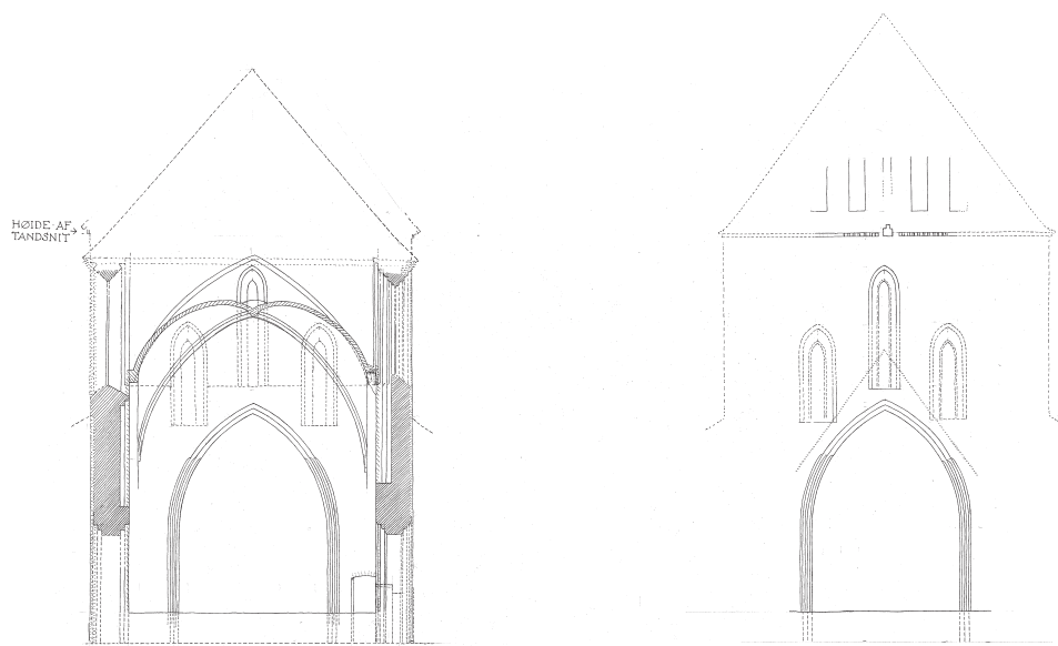
Fig. 177c–d. c. Tværsnit gennem det vestligste fag med rekonstruerede bygningsdele set mod vest. d. Kirkens vestgavl set mod øst. 1:300. Målt og tegnet af Ch. Christensen 1938. I NM. – c. Cross-section through the westernmost bay with reconstructed parts of the building, looking west. d. West gable of the church, looking east.
