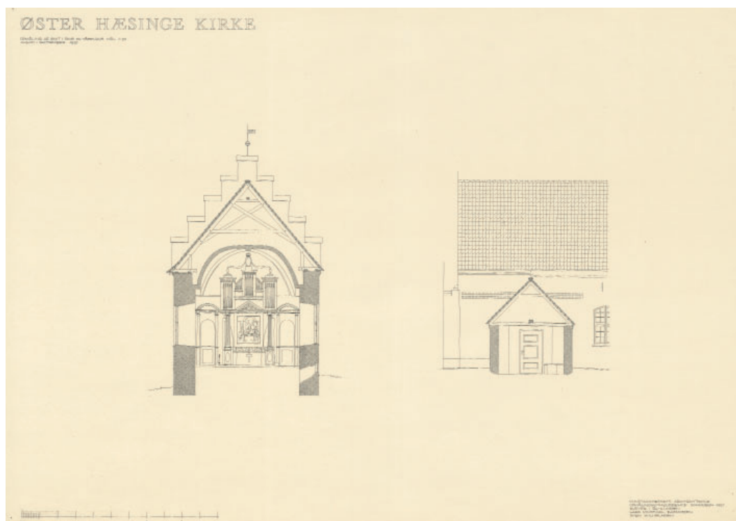
Fig. 20c-d. Opmåling inden istandsættelsen 1964-65 (s. 4213). 1:300. c. Tværsnit gennem koret set mod øst. d. Tværsnit gennem våbenhuset set mod nord. Målt og tegnet af Lars Mindedal Rasmussen og Sven Wilhelmsen 1957. I KB. Kunstbiblioteket. – Scale drawing before the refurbishing in 1964-65. c. Cross-section through the chancel looking east. d. Cross-section through the porch looking north.
