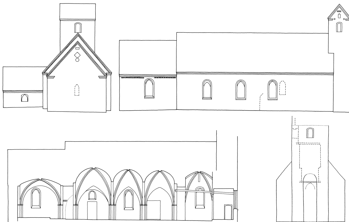
Fig. 6–8. Opstalter og snit 1:300. 6. Opstalter af kirkens øst- og nordside. Målt af H. C. Amberg 1902 og tegnet med enkelte korrektioner af Merete Rude 2011. 7. Længdesnit af kirken set mod syd. 1:300. Målt af H. C. Amberg 1902 og tegnet af Merete Rude 2011. 8. Opstalt af tårnets vestside med angivelse af den oprindelige arkade (s. 1352). Målt og tegnet af Thomas Bertelsen 2003. – Elevations and section. 6. Elevations of the east and north side of the church. 7. Longitudinal section of the church seen towards the south. 8. Elevation of the west side of the tower showing the original arcade.
