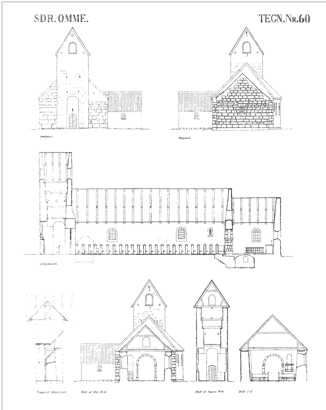
Fig. 6d-j. Opmåling af kirken, 1:300. d. Vestfacade. e. Østfacade. f. Længdesnit set mod nord. g. Detaljer af våbenhus. h. Tværsnit af kor set mod vest. i. Tværsnit af tårn set mod vest. j. Tværsnit af skib set mod øst. Målt og tegnet af E. og F. M. R. Draiby 1951. — Scale drawings of the church. d. West facade. e. East facade. f. Longitudinal section looking north. g. Details of porch. h. Cross-section of chancel looking west. i. Cross-section of tower looking west. j. Cross-section of nave looking east.
