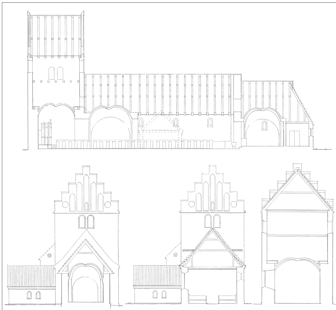
Fig. 26a-h. Opmålinger. 1:300. a. Opstalt af sydfacade. b. Opstalt af vestfacade. c. Opstalt af østfacade d. Opstalt af nordfacade. e. Længdesnit set mod nord. f. Tværsnit i koret set mod vest. g. Tværsnit i skibet set mod vest. h. Tværsnit i tårnet set mod vest. Målt og tegnet af Knud Erik Lauridsen 1990. I NM. – Scale drawings. a. Elevation of south facade. b. Elevation of west facade. c. Elevation of east facade. d. Elevation of north facade. e. Longitudinal section looking north. f. Cross section in chancel looking west. g. Cross section in nave looking west. h. Cross section in tower looking west.
