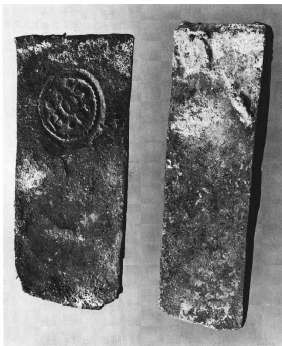
Fig. 60. *Jernkiler - den ene med smedens stempel - benyttet til opspænding af hvælvribber (s. 1458). I NM2. - *Iron wedges - one with the blacksmith's mark - used for tightening the span of the ribs of the vaults.
