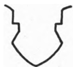
Fig. 12. Greve. Ribbeprofil i Kor. 1:10. Maalt af El. M. 1946 (S. 962).
